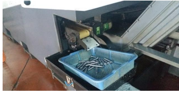
SONRA: Makinanın çıkış konveyörüne eklenecek basınçlı hava düzeneğiyle otomatik çapak temizleme
