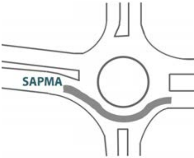
Şekil 79 Dönel kavşakta trafik akımı sapması
