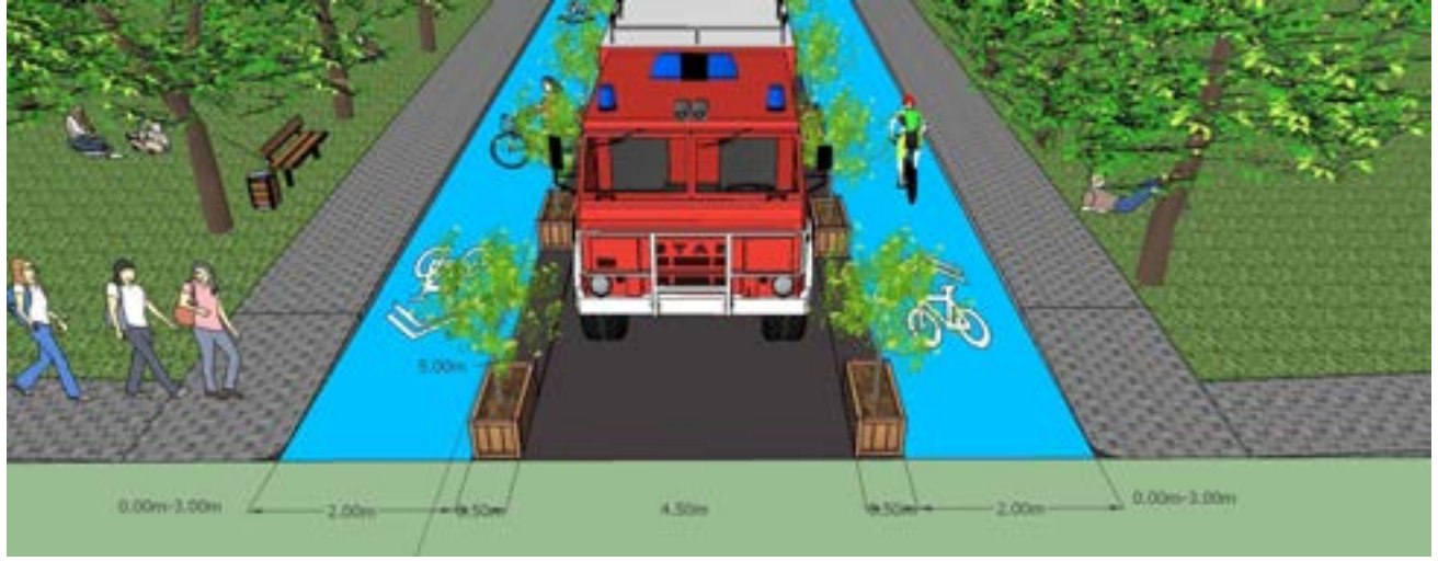
Şekil 61 Namık Kemal Üniversitesi Merkez Yerleşkesi motorlu taşıt trafiğine kapatılacak güzergahlar için kavramsal tasarım örneği
