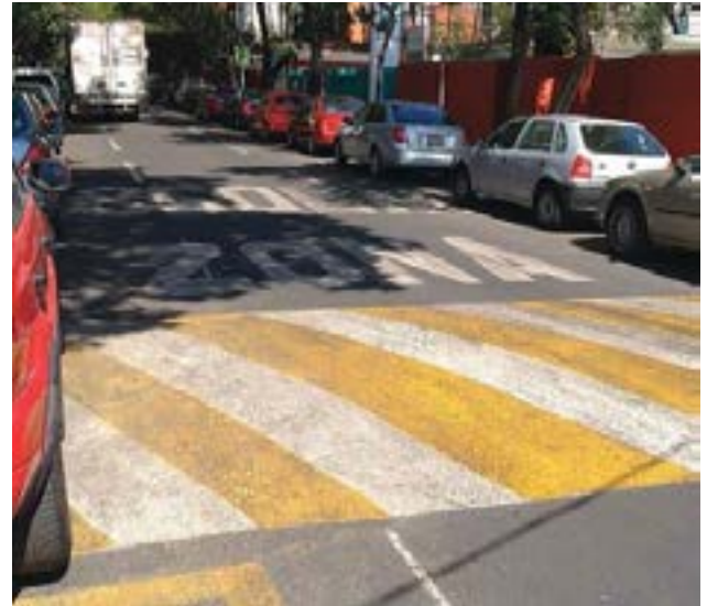
Fotoğraf 90 Yükseltilmiş yaya geçidi örneği (EMBARQ, 2015)
