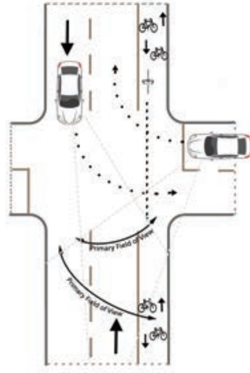
Şekil 105 Bisikletli yol kullanıcılarının akımları (FHA, 2006)
