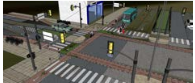
Şekil 90 İstasyon Caddesi'nin güneyinden D-100 Karayolu'nun İstanbul istikametine doğru akan trafik akımı için güvenli bisiklet altyapısına sahip tasarım
