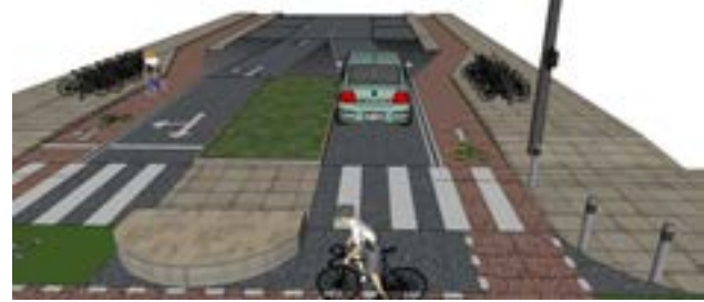
Şekil 98 İstasyon Caddesi'nin güney aksı için yapılan güvenli bisiklet altyapı tasarımı
